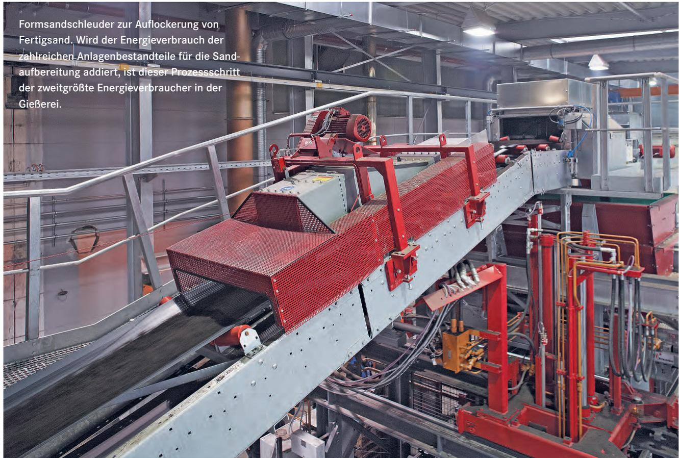
Formsandschleuder zur Auflockerung von Fertigsand. Wird der Energieverbrauch der zahlreichen Anlagenbestandteile für die Sandaufbereitung addiert, ist dieser Prozessschritt der zweitgrößte Energieverbraucher in der Gießerei.
